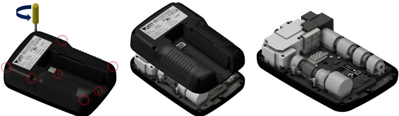
Figure 12 – Retrait du boîtier arrière
