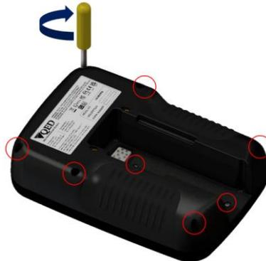
Figure 19 – Ajustement du boîtier arrière
