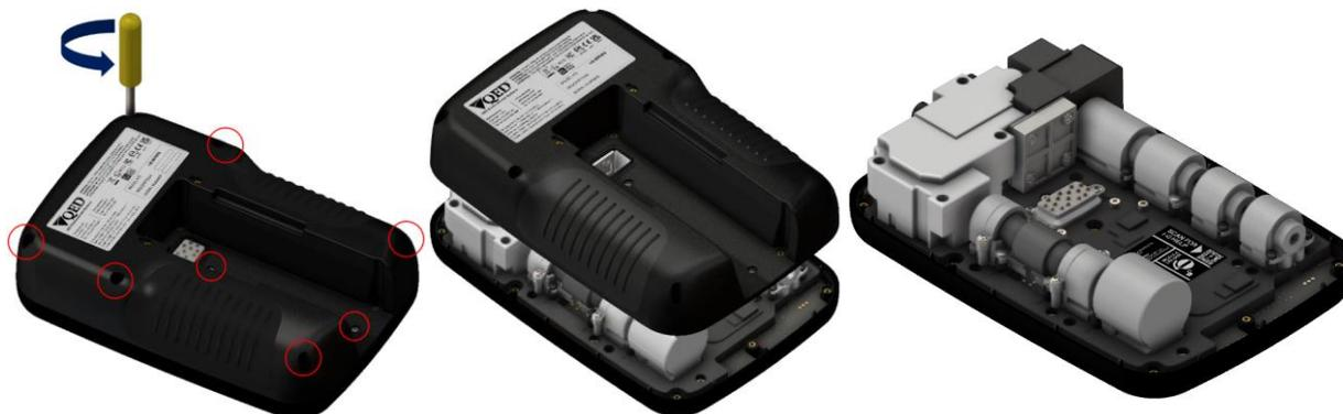
Figure 14 – Retrait du boîtier arrière
