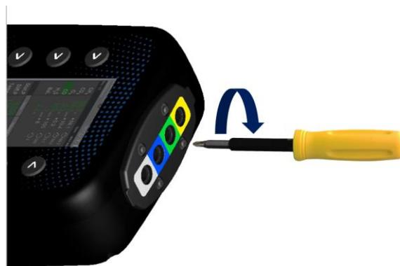
Figure 20 – Ajustement de la plaque des ports d'entrée
